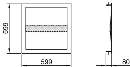
Tensione di alimentazione : 220-240V 50/60 Hz      Ta : - 20°C + 45°C
